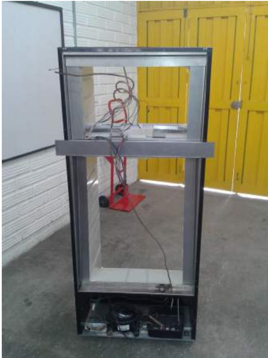
Figura 37. Remoción de recubrimiento plástico interior e instalación de elementos fabricados. Hecha por los autores.
