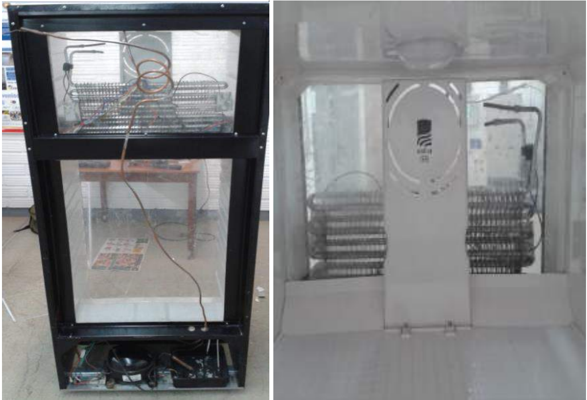
Figura 38. Instalación de acrílico y evaporador. Hechas por los autores.
