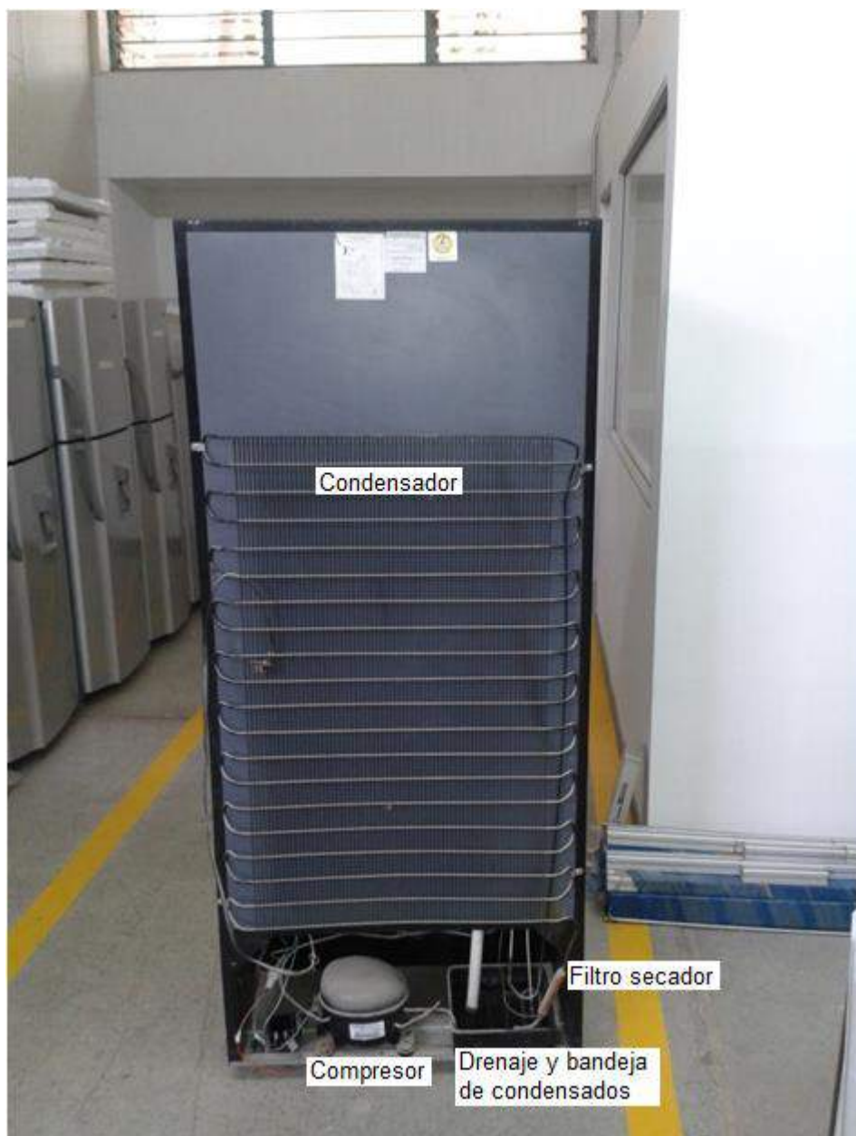
Figura 33. Nevera doméstica usada para la modificación, parte posterior. Hecha por los autores.
