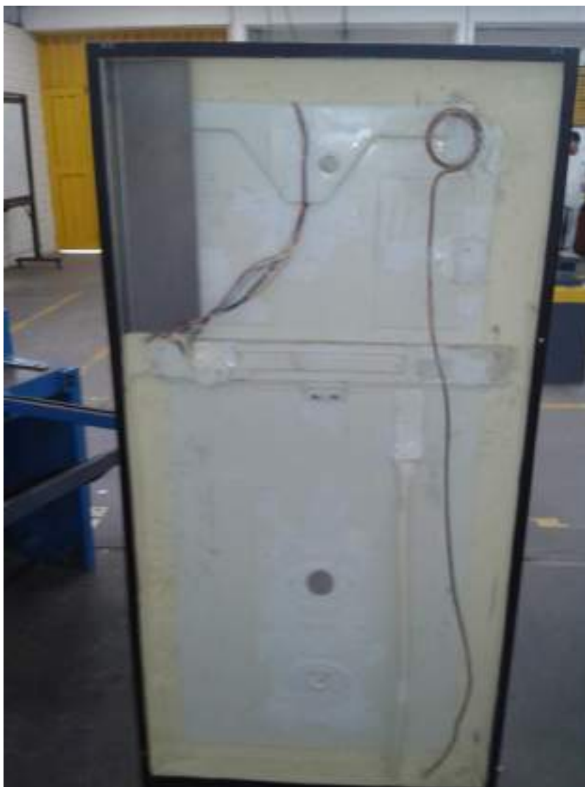
Figura 35. Remoción de espuma de poliuretano de la nevera. Hecha por los autores.
