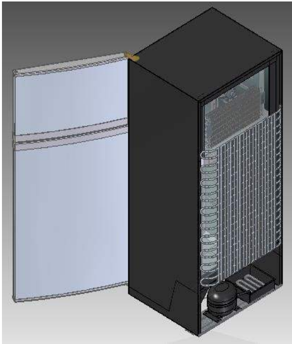
Figura 25. Modelo en CAD del equipo didáctico con modificaciones. Hecha por los autores.
