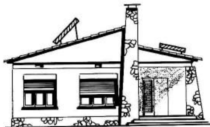
Fig. 6.— Colocación de los paneles solares en los techados.
