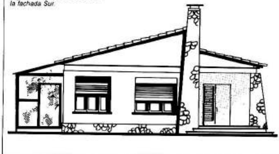
Fig. 6.— Invernadero adosado a la fachada Sur.
