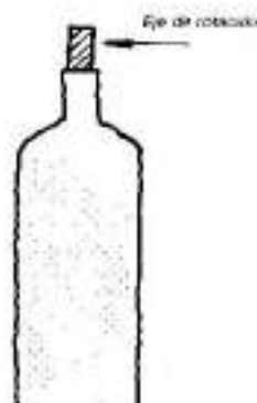
Fig. 1.- Monocristal de silicio. Es un cilindro más o menos rugoso.
