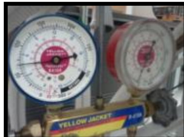
Verificacion : Presion, Voltage, Corriente y diferencia de temperaturas
