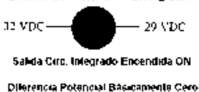
Bobina del Relevador Energizada
